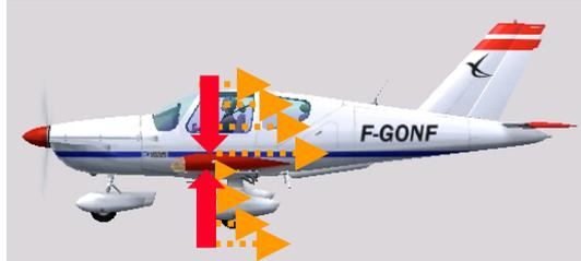
L'écoulement de l'air autour de l'aile n'est pas symétrique. De par la forme même du profil, il y a une différence de vitesse entre l'intrados et l'extrados (Fig. 12). Ce phénomène, dont la description complète fait intervenir la notion de tourbillon de Prandtl, est générateur de la résultante Ra.
